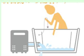
浴槽の排水栓を抜くと追炊き配管内を新しいお湯で洗い流し、湯アカが付くのを防ぎます。その際少し熱めの温度(48℃)を流すため従来より汚れが付着しにくくなります。
